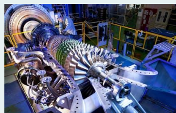
水素ガスタービン
